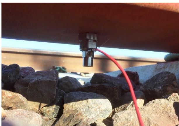
Foto 2: Accelerometer monterad under rälfot vid mätplats Torp
